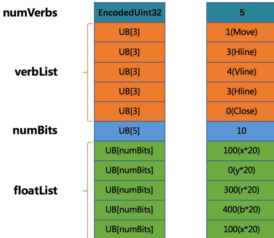
floatList 中每个 Float 值的存储都是先乘以 20 (1 / SPATIAL\_PRECISION), 转换为整型后再存储为 SB[numBits]。其中 numBits 是根据坐标数据中存储的最大值 400 计算得出, 400 的二进制表示为 110010000 需要 9 位, 加上符号位最短一共需要 10 位, 最终得出 numBits 为 10 长度时足够放下 floatList 中的每个数据。
